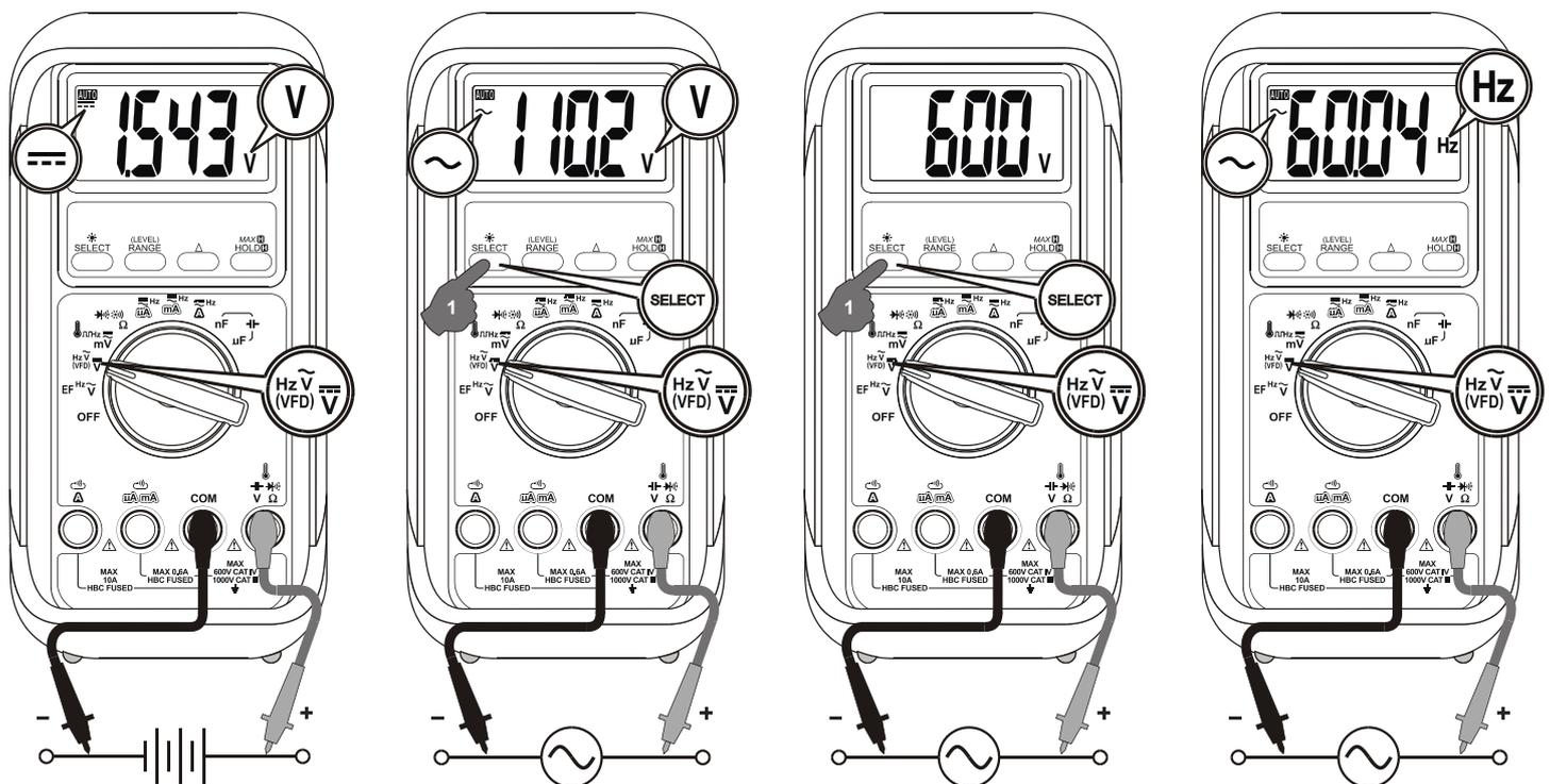
**Hinweis:** VFD-ACV und VFD-Hz sind mit einem digitalen Tiefpassfilter (DSP) ausgestattet und können VFD-Signale (Variable Frequency Drives) für grundlegende V- und Hz-Messwerte verarbeiten. Es verbessert auch die ACV- und Hz-Lesestabilität, wenn es in den meisten elektrisch verrauschten Umgebungen verwendet wird.
