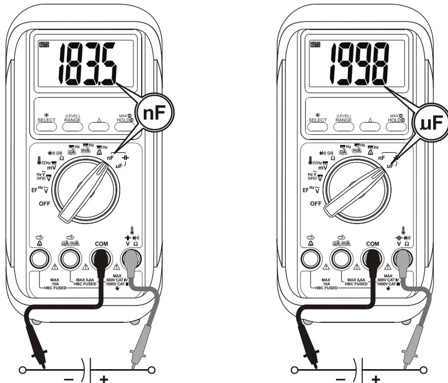
**Notiz:** Entladen Sie den/die Kondensator(en), bevor Sie Kapazitätsmessungen durchführen. Kondensatoren mit hohem Wert sollten durch eine geeignete Widerstandslast entladen werden. Die Verwendung der Kapazitätsfunktion in einem Stromkreis führt zu falschen Ergebnissen und kann das Messgerät beschädigen. In vielen Fällen müssen die verdächtigen Komponenten vom Stromkreis getrennt werden, um genaue Messwerte zu erhalten.
